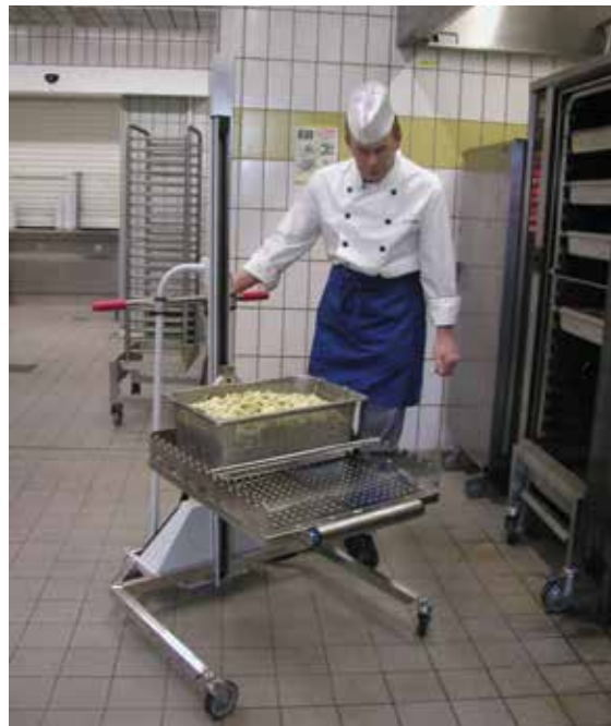
Plattform gelocht, aufgekantet mit Tragrolle
