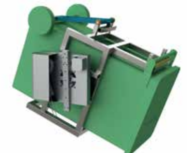
Dreheinheit mit Aufnahme für Papiertonnen
